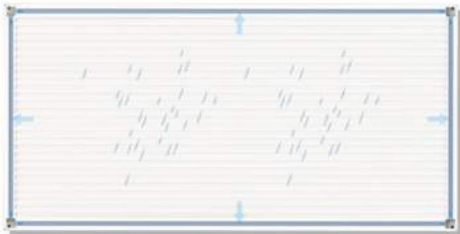
Amélioration du système de drainage: Écoulement de l'eau par les canalisations dans les angles, permettant une évacuation plus efficace et plus sûre
